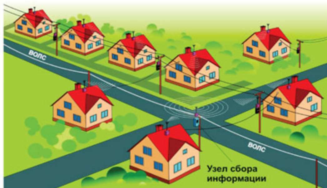
Вариант 1. Сбор показаний по ВОЛС и радиоканалу 433 МГц.
